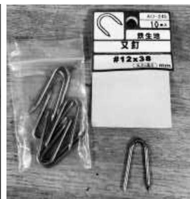
直径7mm、長さ29cmのねじ切り棒を使って又釘を抜いた。ある程度の力に耐えられる太さが必要であったことと、子どもの力でも抜けるだけの長さが必要だったことから選択した。 又釘は扱いやすく、抜いたときに飛んでいかないように、#12×38の物を使用した。繰り返し使用すると又釘が広がっていくので、新しい物と交換しながら使った。
