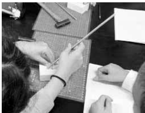
第2種でこを用い、支点からの距離を工夫して又釘を抜く。
