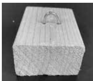
使用した木材はツーバイスリー材。使用する又釘が突き抜けないように厚みがあるものを選んだ。 また、購入した木材は9cm幅でカットした。中央に又釘を打ち込んで渡すことで、第1種でこでは簡単に抜けないようにした。
