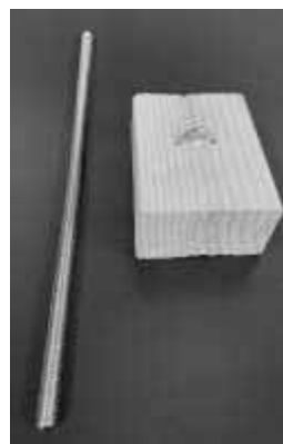
直径7mm、長さ29cmのねじ切り棒を使って又釘を抜いた。ある程度の力に耐えられる太さが必要であったことと、子どもの力でも抜けるだけの長さが必要だったことから選択した。 又釘は扱いやすく、抜いたときに飛んでいかないように、#12×38の物を使用した。繰り返し使用すると又釘が広がっていくので、新しい物と交換しながら使った。
