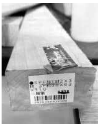
使用した木材はツーバイスリー材。使用する又釘が突き抜けないように厚みがあるものを選んだ。 また、購入した木材は9cm幅でカットした。中央に又釘を打ち込んで渡すことで、第1種でこでは簡単に抜けないようにした。
