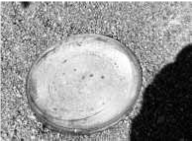
プラスチックのシャーレを使い、乾いているグラウンドの地面からの蒸発を捉えた。気温が15℃以上ある日であれば、地面が乾いている日でも数秒でくもり、水蒸気が出ていることが分かる。気温が低くなると、日向であってもしばらく待たないとくもらない。(次時)
